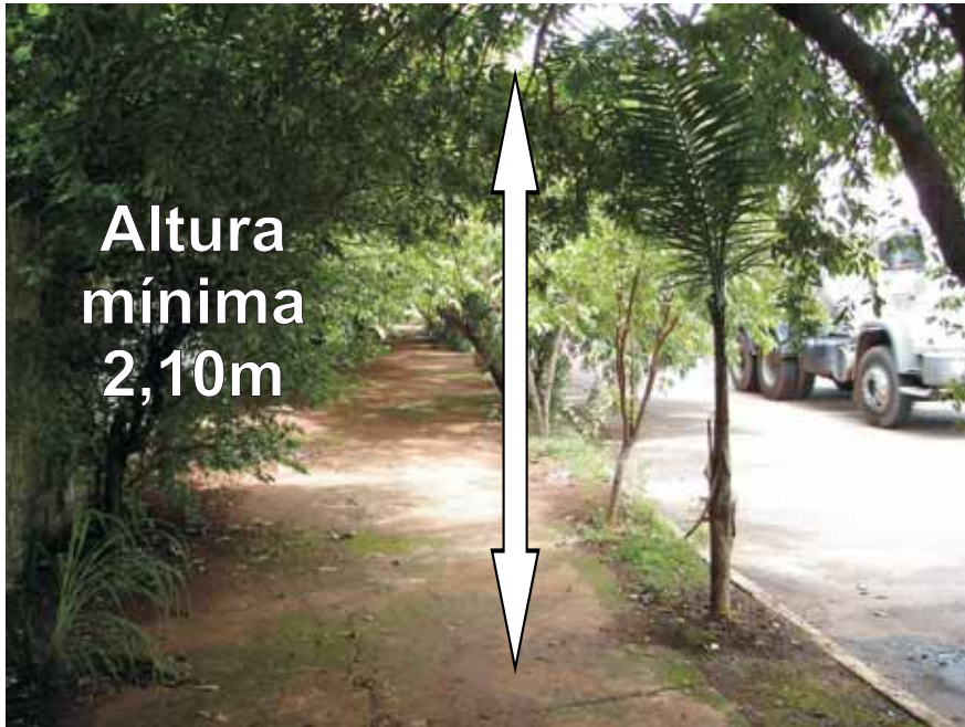
Foto 3: Exemplo de obstáculo aéreo impedindo a livre circulação pelo passeio público. (Fonte: Francisco O. M. do Amaral)
