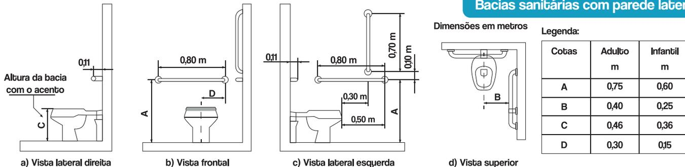
Bacia convencional com barras de apoio ao fundo e a 90° na parede lateral
