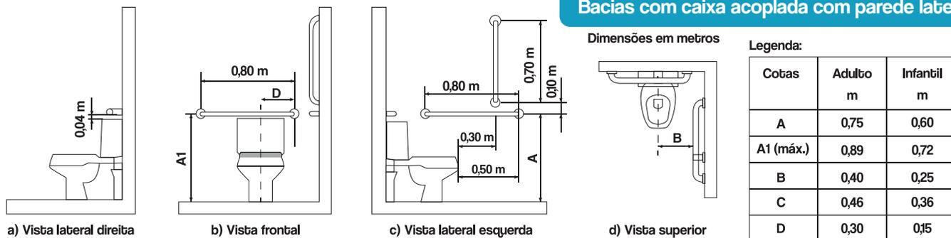
Bacia com caixa acoplada com barras de apoio ao fundo e a 90° na parede lateral
