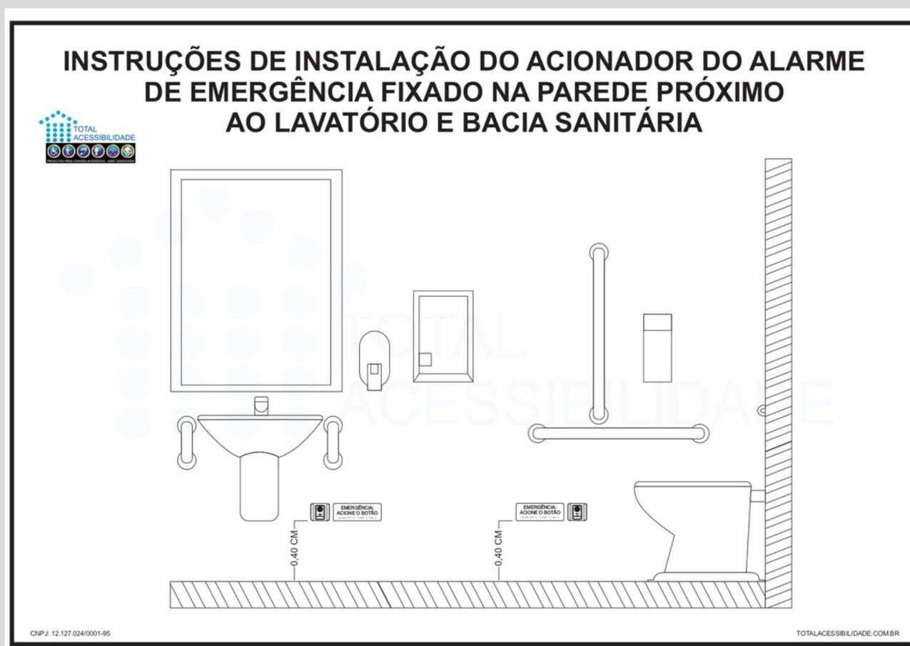
Ilustração do posicionamento dos alarmes instalados no Sanitário Acessível
