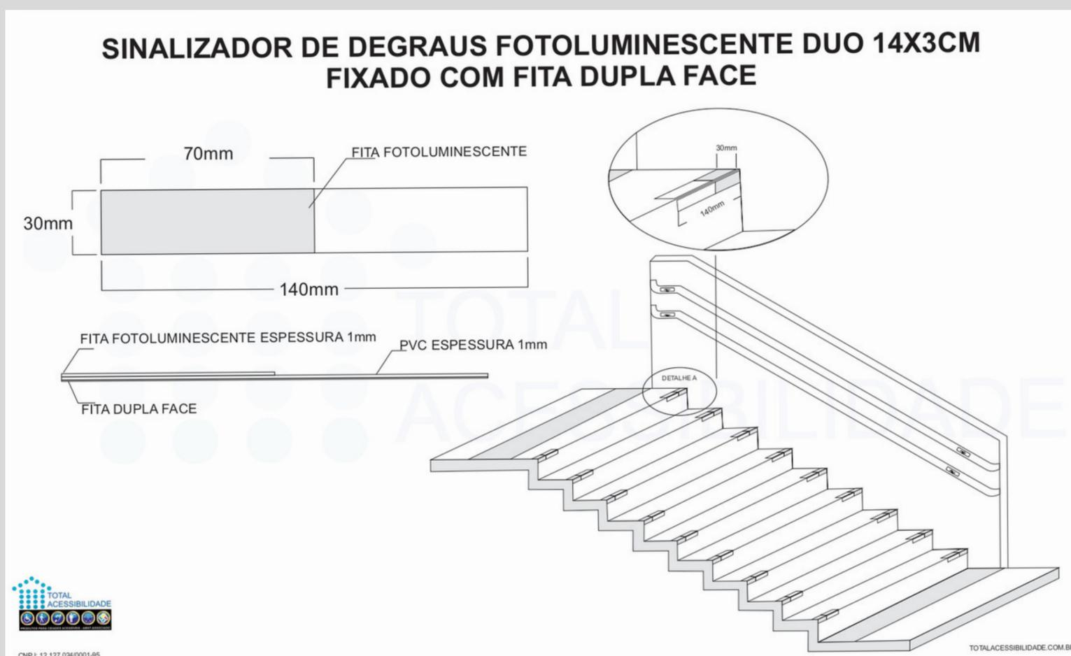
Ilustração do posicionamento do sinalizador de degraus fotoluminescente 14x3CM fixado por Fita Dupla Face 3M
