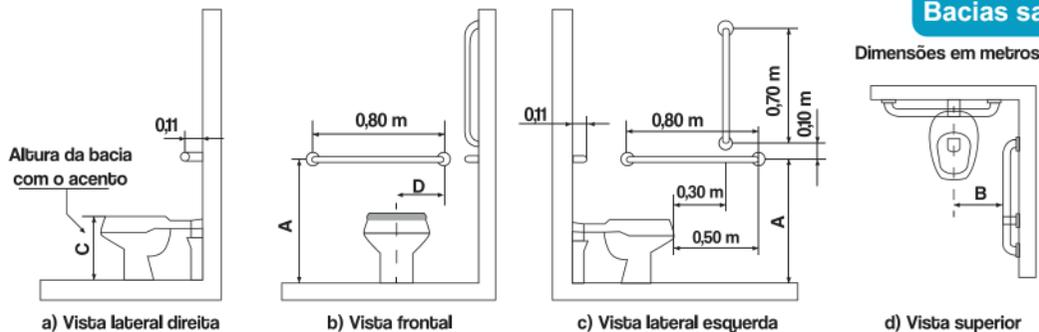
Bacia convencional com barras de apoio ao fundo e a 90° na parede lateral
