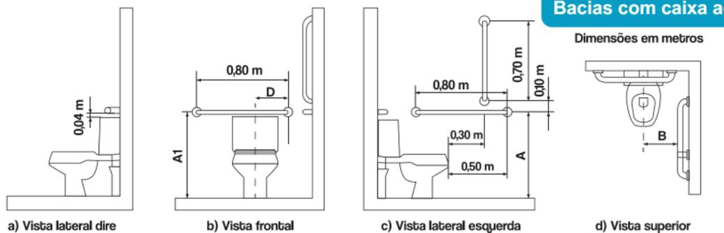
Bacia com caixa acoplada com barras de apoio ao fundo e a 90° na parede lateral
