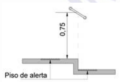
a) Barra de apoio inclinada
